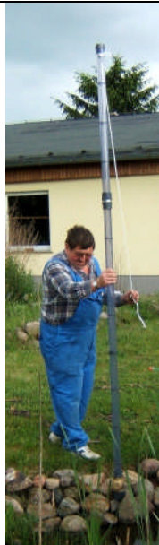
Abb. Grundelement 2 m + Verlängerung 1 m (Markierungen alle 25 cm)
